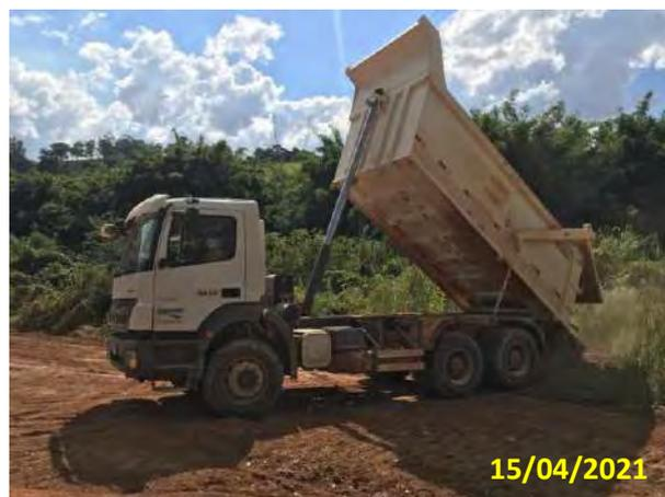
**Foto 10** – Caminhão Basculante realizando o descarregamento do material florestal no pátio de raízes.
